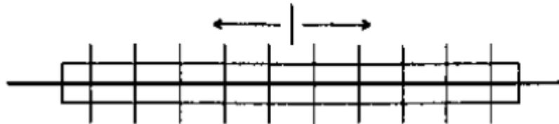
図 2-1 ボルト締め付け順序
