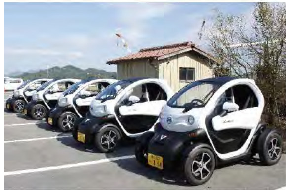
超小型モビリティ・日産ニューモビリティコンセプト
