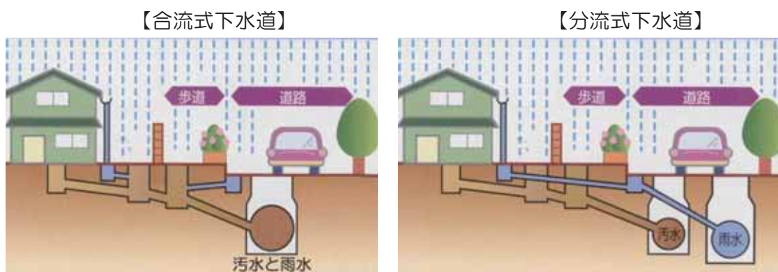
図 1-3 合流式下水道・分流式下水道の概要図
