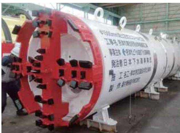
図 2-20 東別府雨水幹線の建設工事に使用しているシールドマシン
