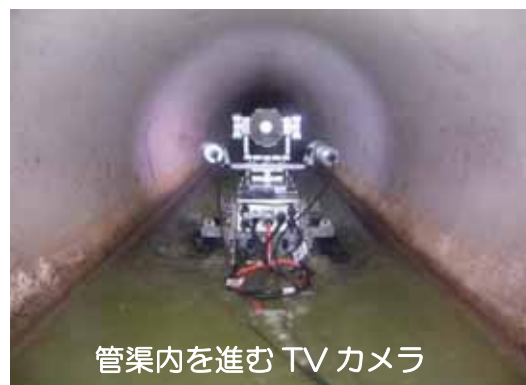
図 2-5 TVカメラ調査中の管渠内の様子
