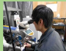
<微細金型溶接補修、機械加工での加工欠損部補修>
